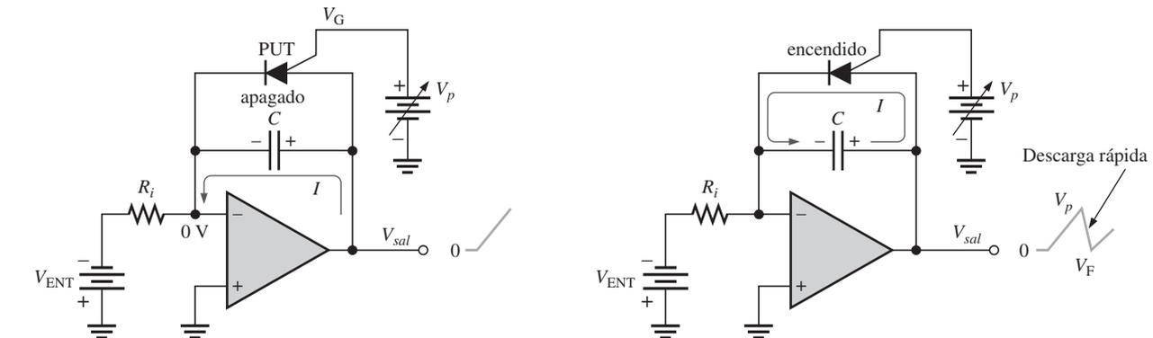
(a) Inicialmente, el capacitor se carga, la rampa de salida se inicia y el PUT se apaga.
