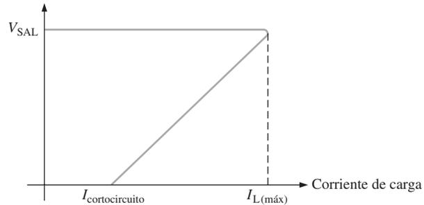
La ventaja de esta técnica es permitir al regulador operar con corriente de carga pico hasta  $I_{L(\text{máx})}$ , pero cuando la salida se pone en cortocircuito, la corriente se reduce a un valor bajo para evitar que el dispositivo se sobrecaliente.
