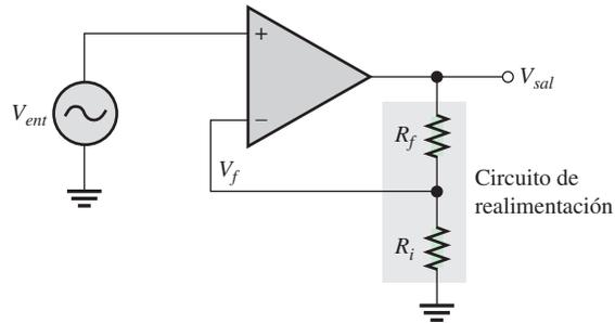
La diferencia del voltaje de entrada,  $V_{ent}$  y el voltaje de realimentación,  $V_f$ , es la entrada diferencial al amplificador operacional, como muestra la figura 12-16. Este voltaje diferencial es amplificado por la ganancia de voltaje en lazo abierto del amplificador operacional ( $A_{ol}$ ) y produce un voltaje de salida expresado como
