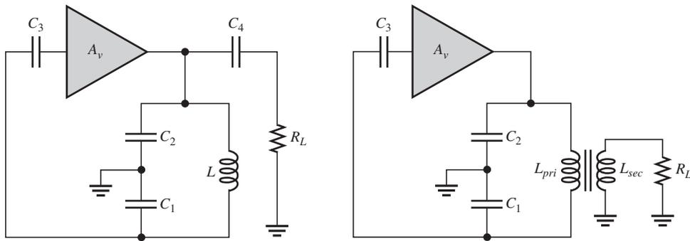
(a) Una carga acoplada capacitivamente a la salida del oscilador puede reducir el factor  $Q$  y la  $f_r$  del circuito.
