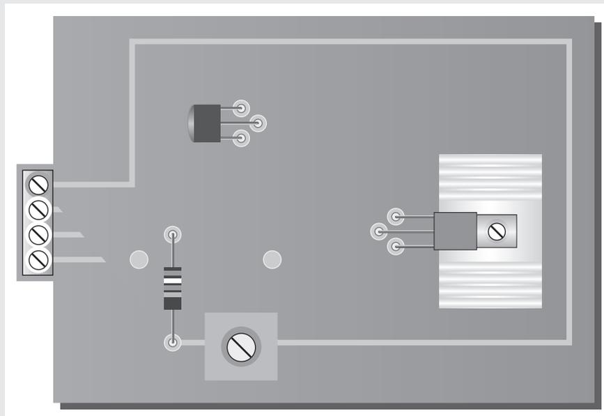
7. Revise la tarjeta de circuito impreso en cuanto a corrección comparándola con el diagrama esquemático de la figura 11-46.
