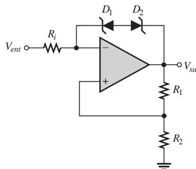
dría estar defectuoso. Por ejemplo, suponga que uno de los diodos zener se abre. Esto efectivamente elimina a ambos y el circuito opera como un comparador no acotado, como se indica en la figura 13-45(a). Con un diodo en cortocircuito, la salida se limita al voltaje zener (acotado) sólo en una dirección, según cual diodo permanezca en operación, como se ilustra en la figura 13-45(b). En la otra dirección, la salida se mantiene al voltaje de diodo en directa.
