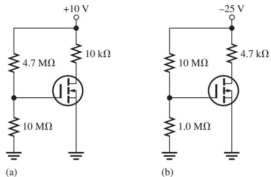
41. Determine el  $V_{DS}$  para cada uno de los circuitos de la figura 8-75.  $I_{DSS} = 8 \text{ mA}$ .
