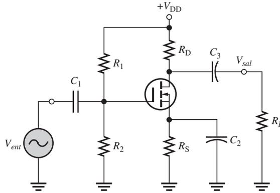
Como en los casos del JFET y del D-MOSFET, el voltaje de señal hace que  $V_{gs}$  excursione, por encima y por debajo de su valor en el punto Q,  $V_{GSQ}$ . Esto a su vez, que  $I_d$  excursione por encima y por debajo de su valor de punto Q,  $I_{DQ}$ , como lo ilustra la figura 9-15. La operación ocurre por completo en el modo de enriquecimiento.
