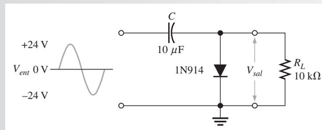
**Solución** Idealmente, el circuito sujetador inserta un valor de cd negativo igual al pico de entrada menos la caída de diodo.
