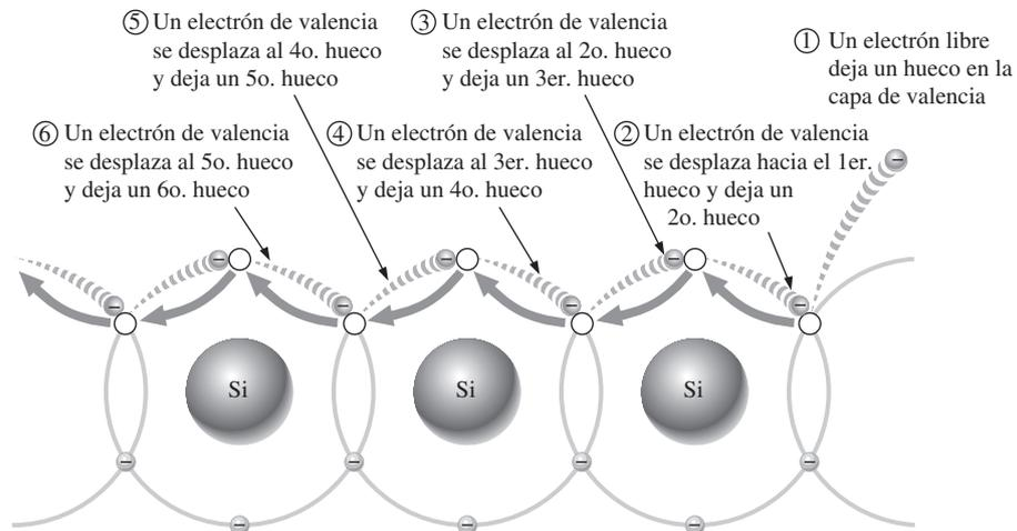
Cuando un electrón de valencia se desplaza de izquierda a derecha mientras deja detrás un hueco, éste se ha movido efectivamente de derecha a izquierda. Las flechas gruesas indican el movimiento efectivo de un hueco.
