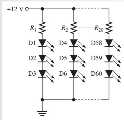
**Problema relacionado** Diseñe un conjunto de LED rojos de 12 V con el mínimo de resistores limitadores, una corriente en polarización en directa de 30 mA y que contenga 64 diodos.
