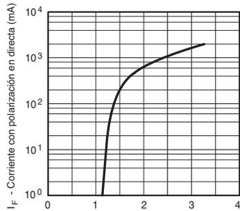
(b) VF - Voltaje con polarización en directa (V)
