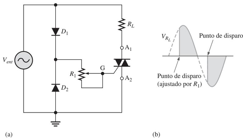
El diodo  $D_2$  conduce durante el semiciclo negativo y  $R_1$  fija el punto de disparo. Observe que durante esta parte del ciclo de ca,  $A_2$  y G son positivos con respecto a  $A_1$ . La forma de onda resultante a través de  $R_L$  se muestra en la figura 11-31(b).
