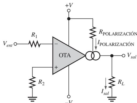
Puesto que  $V_{sal}/V_{ent}$  es la ganancia de voltaje e  $I_{sal}/V_{ent} = g_m$ .
