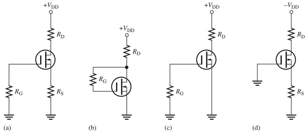
40. Cada E-MOSFET que aparece en la figura 8-74 tiene un  $V_{GS(\text{umbral})}$  de  $+5 \text{ V}$  o  $-5 \text{ V}$ , dependiendo de si es un dispositivo de canal  $n$  ó uno de canal  $p$ . Determine cada uno de los MOSFET está encendido o apagado.
