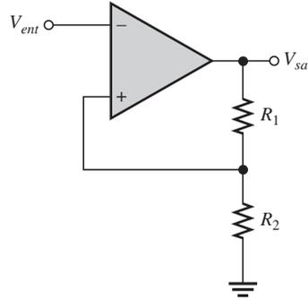
La operación básica del comparador con histéresis se ilustra en la figura 13-8. Considere que el voltaje de salida se encuentra a sus máximo positivo,  $+V_{sal(máx)}$ . El voltaje realimentado a la entrada no inversora es  $V_{UTP}$  y se expresa como
