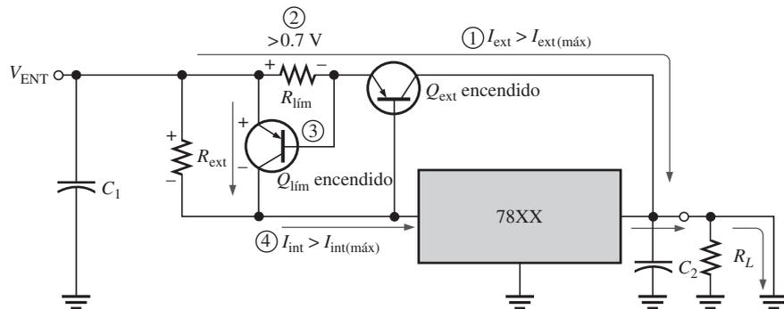
(b) Cuando ocurre un corte en ①, la corriente externa se vuelve excesiva y el voltaje a través de  $R_{lim}$  se incrementa en ② y  $Q_{lim}$  se enciende ③, el que luego encauza corriente a través del regulador y la conduce alejándose de  $Q_{ext}$  y hace que la corriente interna en el regulador se vuelva excesiva ④ lo que hace que el regulador entre en interrupción térmica.
