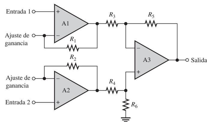
El resistor que ajusta la ganancia,  $R_G$ , se conecta externamente como muestra la figura 14-2. El amplificador operacional A1 recibe la señal de entrada diferencial,  $V_{ent1}$ , en su entrada no inversora (+) y la amplifica con una ganancia de voltaje de
