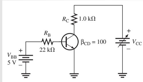
**Solución** En primer lugar, determine  $I_B$  de tal forma que pueda determinar  $I_C$
