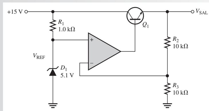
**Solución**  $V_{REF} = 5.1 \text{ V}$ , el voltaje zener. En consecuencia, el voltaje de salida regulado es
