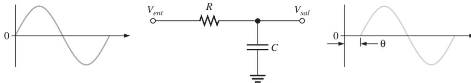
El signo negativo indica que la salida atrasa la entrada. Esta ecuación muestra que el desfase se incrementa con la frecuencia y tiende a  $-90^\circ$  a medida que la frecuencia llega a ser mucho más grande que  $f_c$ .
