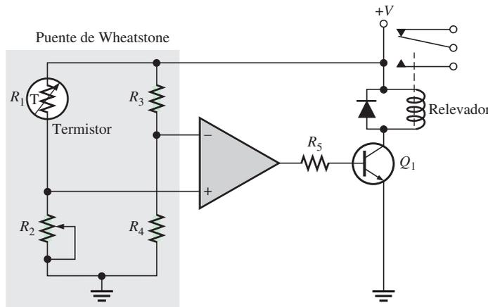
A medida que se incrementa la temperatura, la resistencia del termistor se reduce. Cuando la temperatura alcanza el valor crítico,  $R_1$  llega a ser igual a  $R_2$  y el puente se desbalancea (puesto que  $R_3 = R_4$ ). En este momento el amplificador operacional cambia a su nivel alto de salida de saturación y  $Q_2$  se enciende. Esto energiza el relevador, el cual puede ser utilizado para activar una alarma o iniciar un respuesta apropiada a la condición de sobre temperatura.
