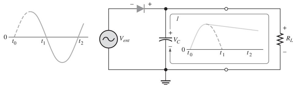
(b) El capacitor se descarga través de  $R_L$  después del pico de alternancia positiva cuando el diodo está polarizado en inversa. Esta descarga ocurre durante la parte del voltaje de entrada indicada por la curva continua.
