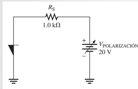
**Solución** El voltaje en el ánodo,  $V_A$  es de 0.9. El voltaje a través de  $R_S$  es
