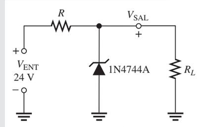
**Solución** Primero, repase el ejemplo 3-6. El zener 1N4744A utilizado en el circuito regulador de la figura 3-15 es un diodo de 15 V. La hoja de datos de la figura 3-7 da la siguiente información:  $V_Z = 15\text{ V}$  con  $I_Z = 17\text{ mA}$ ,  $I_{ZK} = 0.25\text{ mA}$  y  $Z_Z = 14\ \Omega$ .
