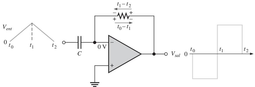
Observe en la ecuación 13-8 que el término  $V_C/t$  es la pendiente de la entrada. Si la pendiente se incrementa,  $V_{sal}$  se incrementa. Si la pendiente se reduce,  $V_{sal}$  se reduce. El voltaje de salida es proporcional a la pendiente (razón de cambio) de la entrada. La constante de proporcionalidad es la constante de tiempo  $R_f C$ .
