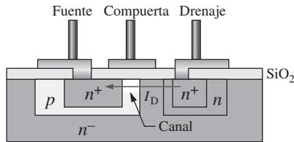
**VMOSFET** El MOSFET de ranura en V es otro ejemplo del E-MOSFET convencional diseñado para alcanzar una capacidad de potencia más alta, creando un canal más corto y más ancho con menos resistencia entre el drenaje y la fuente por medio de una estructura de canal vertical. Los canales más cortos y anchos permiten corrientes más altas y, por lo tanto, una disipación de potencia más grande. También mejora la respuesta a frecuencia.
