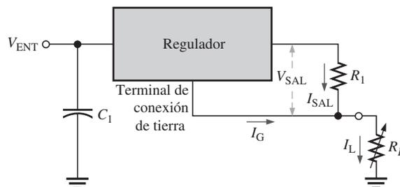
$V_{SAL}$ , entre la terminal de tierra (no conectada a tierra en este caso) y la terminal de salida. Esto determina la corriente constante suministrada a la carga.
