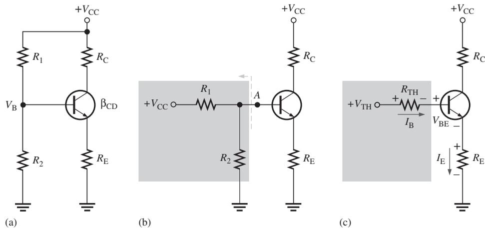
El equivalente Thevenin del circuito de polarización, conectado a la base del transistor, se muestra en el recuadro gris de la figura 5-13(c). Aplicando la ley de voltaje de Kirchhoff alrededor de la malla base-emisor equivalente se obtiene
