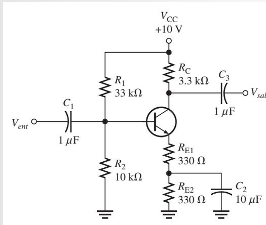
**Solución**  $R_{E2}$  es puenteado por medio de  $C_2$ .  $R_{E1}$  es más de diez veces  $r'_e$  de modo que la ganancia de voltaje aproximada es
