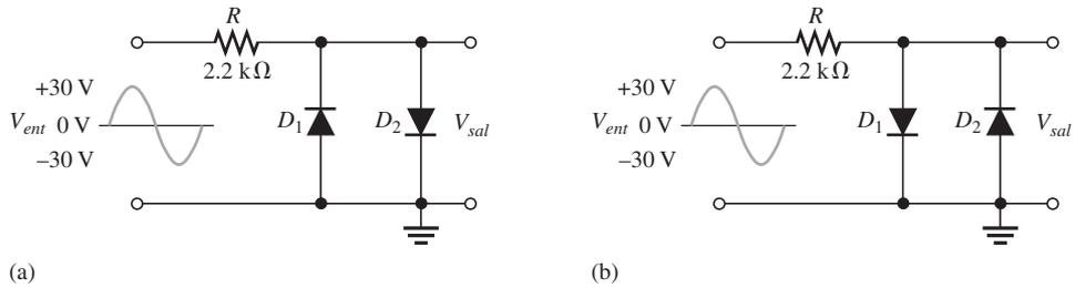
29. Determine la corriente pico de polarización en directa a través de cada uno de los diodos de la figura 2-84.
