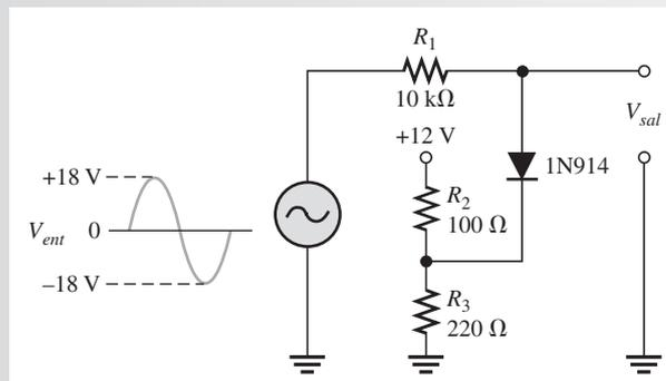
**Solución** El circuito es un limitador positivo. Use la fórmula del divisor de voltaje para determinar el voltaje de polarización.
