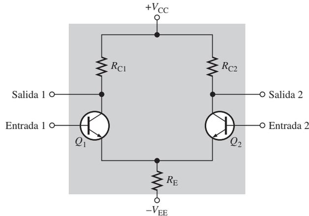
El siguiente razonamiento corresponde a la figura 6-38 y es un análisis básico en cd de la operación del amplificador diferencial. En primer lugar, cuando ambas entradas están conectadas a tierra (0 V), los emisores están a  $-0.7$  V, como se indica en la figura 6-38(a). Se supone que los transistores son idénticos gracias a un cuidadoso control del proceso durante su fabricación, de tal suerte que las corrientes en cd en sus emisores son iguales cuando no hay señal de entrada. Así pues,
