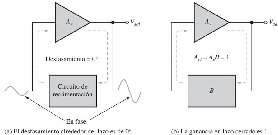
La ganancia de voltaje alrededor del lazo de realimentación cerrado,  $A_{cl}$ , es el producto de la ganancia del amplificador,  $A_v$ , por la atenuación,  $B$ , del circuito de realimentación.
