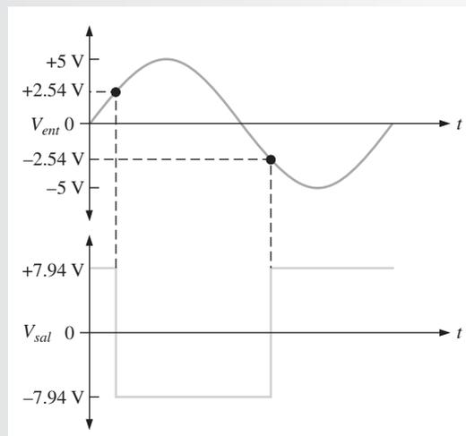
**Problema relacionado** Determine los puntos de disparo alto y bajo para la figura 13-13 con  $R_1 = 150 \text{ k}\Omega$ ,  $R_2 = 68 \text{ k}\Omega$  y los diodos zener son dispositivos de 3.3 V.
