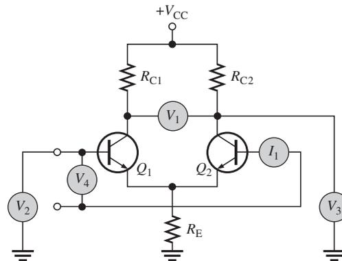
38. Una etapa de un amplificador diferencial tiene resistores en los colectores de  $5.1\text{ k}\Omega$  cada uno. Si  $I_{C1} = 1.35\text{ mA}$  e  $I_{C2} = 1.29\text{ mA}$ , ¿cuál es el voltaje de salida diferencial?
