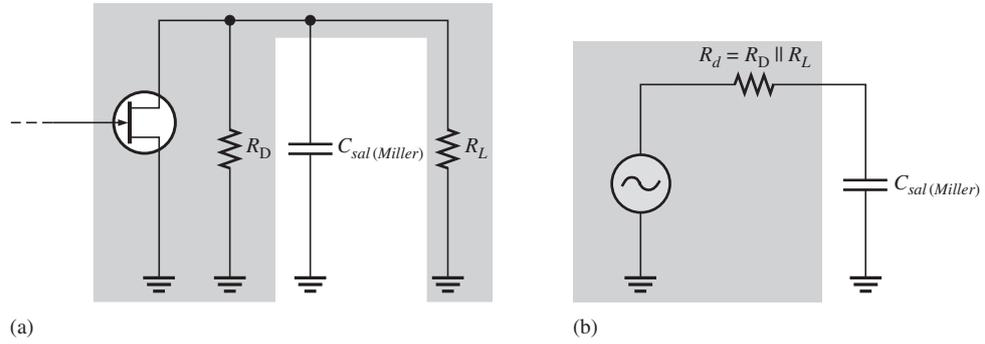
Este circuito de salida equivalente se muestra en la figura 10-43(b). La frecuencia crítica del circuito de atraso RC de salida es
