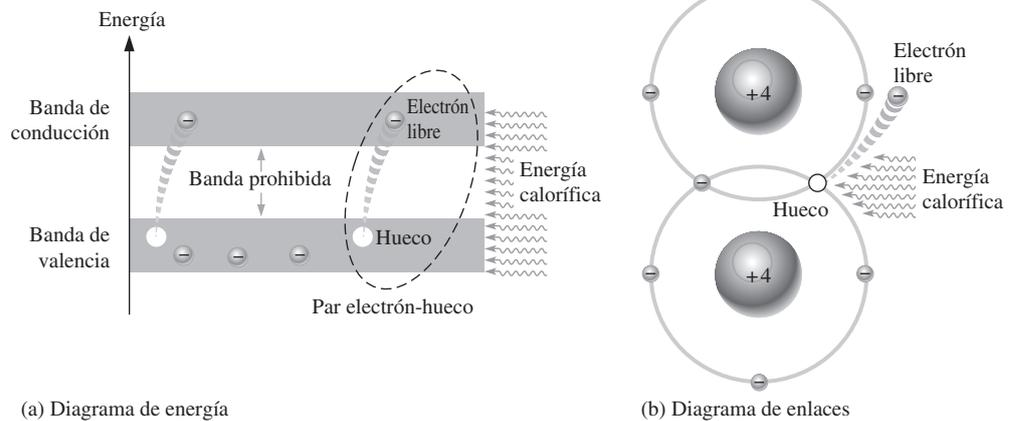
Cuando un electrón salta a la banda de conducción, deja un espacio vacío en la banda de valencia dentro del cristal. Este espacio vacío se llama **hueco**. Por cada electrón elevado a la banda de conducción por medio de energía externa queda un hueco en la banda de valencia y se crea lo que se conoce como **par electrón-hueco**; ocurre una **recombinación** cuando un electrón de banda de conducción pierde energía y regresa a un hueco en la banda de valencia.
