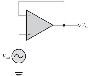
Las características más importantes de la configuración de seguidor de voltaje son su muy alta impedancia de entrada y su muy baja impedancia de salida. Estas características hacen que esta configuración sea un amplificador separador casi ideal para conectar fuentes de alta impedancia con cargas de baja impedancia. Esto se discute más a fondo en la sección 12-5.
