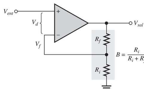
Sustituyendo  $BV_{sal}$  por el voltaje de realimentación,  $V_f$ , se obtiene
