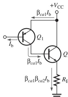
como *Darlington complementario* o *transistor compuesto*. La ganancia de corriente es aproximadamente igual a la del par Darlington, como se ilustra. La diferencia es que la corriente en la base  $Q_2$  es la corriente en el colector  $Q_1$ , en lugar de la corriente en el emisor, como en la configuración del Darlington.
