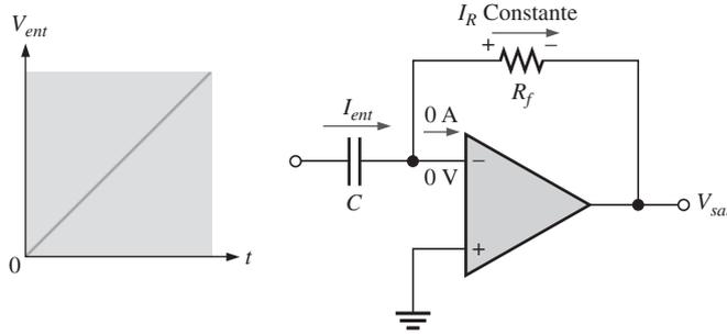
Como la corriente en la entrada inversora es despreciable,  $I_R = I_C$ . Ambas corrientes son constantes porque la pendiente del voltaje en el capacitor ( $V_C/t$ ) es constante. El voltaje de salida también es constante e igual al voltaje a través de  $R_f$ , porque un lado del resistor de realimentación siempre está a 0 V (tierra virtual).
