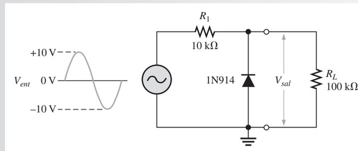
**Solución** El diodo está polarizado en directa y conduce cuando el voltaje de entrada se va a menos de  $-0.7\text{ V}$ . Por lo tanto, para el limitador negativo, se determina el voltaje pico de salida a través de  $R_L$  con la siguiente ecuación
