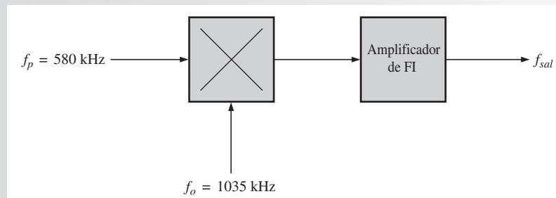
**Solución** El amplificador de FI produce sólo la señal de diferencia de frecuencias en su salida.
