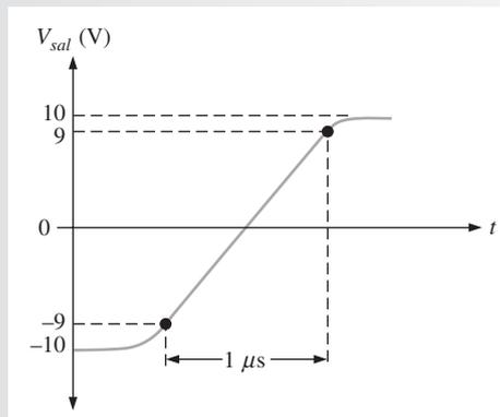
**Solución** La salida cambia del límite inferior al superior en  $1 \mu s$ . Puesto que esta respuesta no es ideal, los límites se toman en los puntos correspondientes al 90%, como se indica. Así que, el límite superior es de  $+9 V$  y el inferior es de  $-9 V$ . La rapidez de variación de voltaje es
