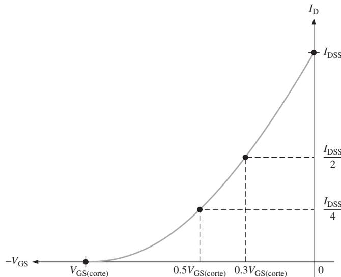
Observe que el extremo inferior de la curva se encuentra en un punto sobre el eje  $V_{GS}$  igual a  $V_{GS(\text{corte})}$  y el superior se encuentra en un punto sobre el eje  $I_D$  igual a  $I_{DSS}$ . Esta curva muestra que
