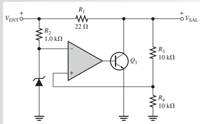
**Solución** La disipación de potencia en el peor caso en  $R_1$  ocurre cuando la salida se pone en cortocircuito y  $V_{SAL} = 0$ . Cuando  $V_{ENT} = 12.5$  V y la caída de voltaje a través de  $R_1$  es
