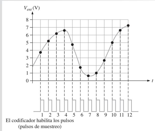
**Solución** La secuencia de salida binaria resultante se da a continuación y se muestra en el diagrama de forma de onda de la figura 13-18 en relación con los pulsos de muestreo.
