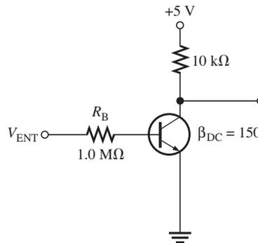
30. El transistor de la figura 4-59 tiene una  $\beta_{CD}$  de 50. Determine el valor de  $R_B$  requerido para garantizar la saturación cuando  $V_{ENT}$  es de 5 V. ¿Cuál debe ser  $V_{ENT}$  para cortar el transistor? Suponga  $V_{CE(sat)} = 0$  V.
