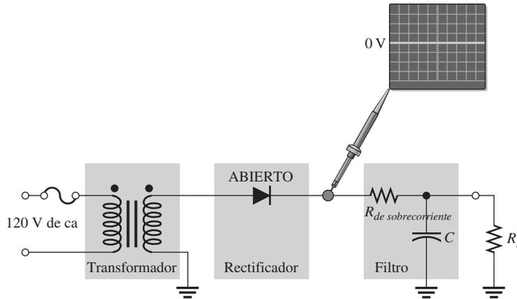
**Efecto de un diodo abierto en un rectificador de onda completa** La figura 2-62 muestra un rectificador de onda completa filtrado con derivación central. Si cualquiera de los dos diodos está abierto, el voltaje de salida tendrá dos veces el voltaje de rizo normal a 60 Hz en lugar de a 120 Hz, como se indica.
