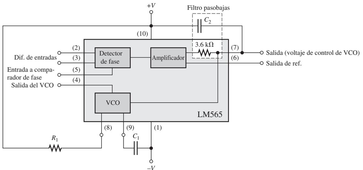
▲ FIGURA 18-47 Diagrama de bloques del PLL LM565.
