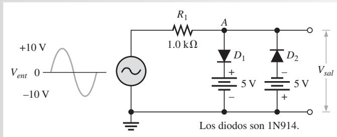
**Solución** Cuando el voltaje en el punto A alcanza +5.7 V, el diodo  $D_1$  conduce y limita la forma de onda a +5.7 V. El diodo  $D_2$  no conduce hasta que el voltaje alcanza -5.7 V. Por consiguiente, los voltajes positivos de más de +5.7 V y los voltajes negativos de menos de -5.7 V se recortan. La forma de onda de voltaje de salida resultante se muestra en la figura 2-41.
