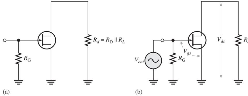
**Voltaje de señal en la compuerta** Se muestra una fuente de voltaje de ca conectada a la entrada en la figura 9-8(b). Puesto que la resistencia de entrada a un FET es extremadamente alta, prácticamente todo el voltaje de entrada de la fuente de señales aparece en la compuerta con una caída de voltaje muy pequeña a través de la resistencia interna de la fuente.
