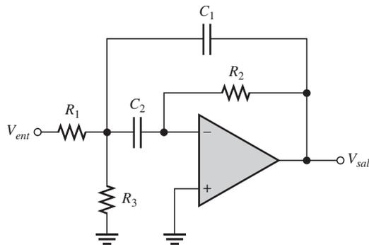
Una expresión para la frecuencia central se desarrolla como sigue, reconociendo que  $R_1$  y  $R_3$  aparecen en paralelo como se ve desde la trayectoria de realimentación  $C_1$  (con la fuente  $V_{ent}$  reemplazada por un corto).
