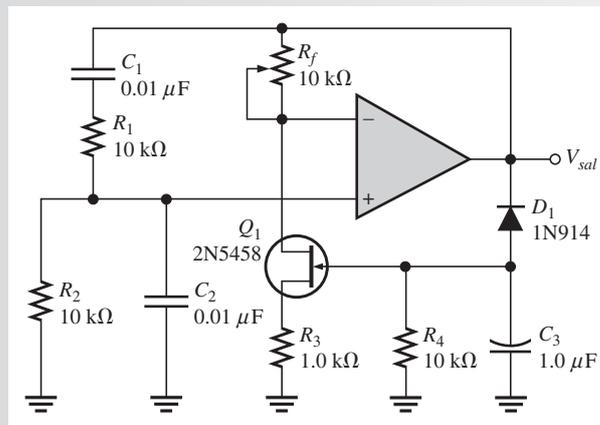
**Solución** Para el circuito de adelanto-atraso,  $R_1 = R_2 = R = 10\ \text{k}\Omega$  y  $C_1 = C_2 = C = 0.01\ \mu\text{F}$ . La frecuencia es
