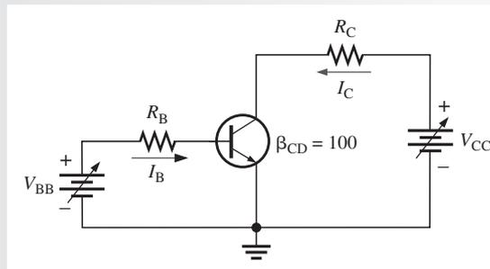
**Solución** Utilizando la relación  $I_C = \beta_{CD}I_B$ , los valores de  $I_C$  se calculan y tabulan en la tabla 4-1. Las curvas resultantes aparecen en la figura 4-12.
