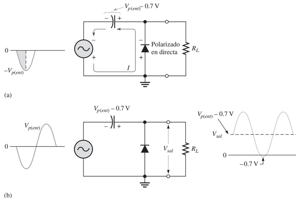
a través de la resistencia de  $R_L$ . Así que, desde el pico de un semiciclo negativo hasta el siguiente, el capacitor se descarga muy poco. La cantidad que se descarga, desde luego, depende del valor de  $R_L$ .
