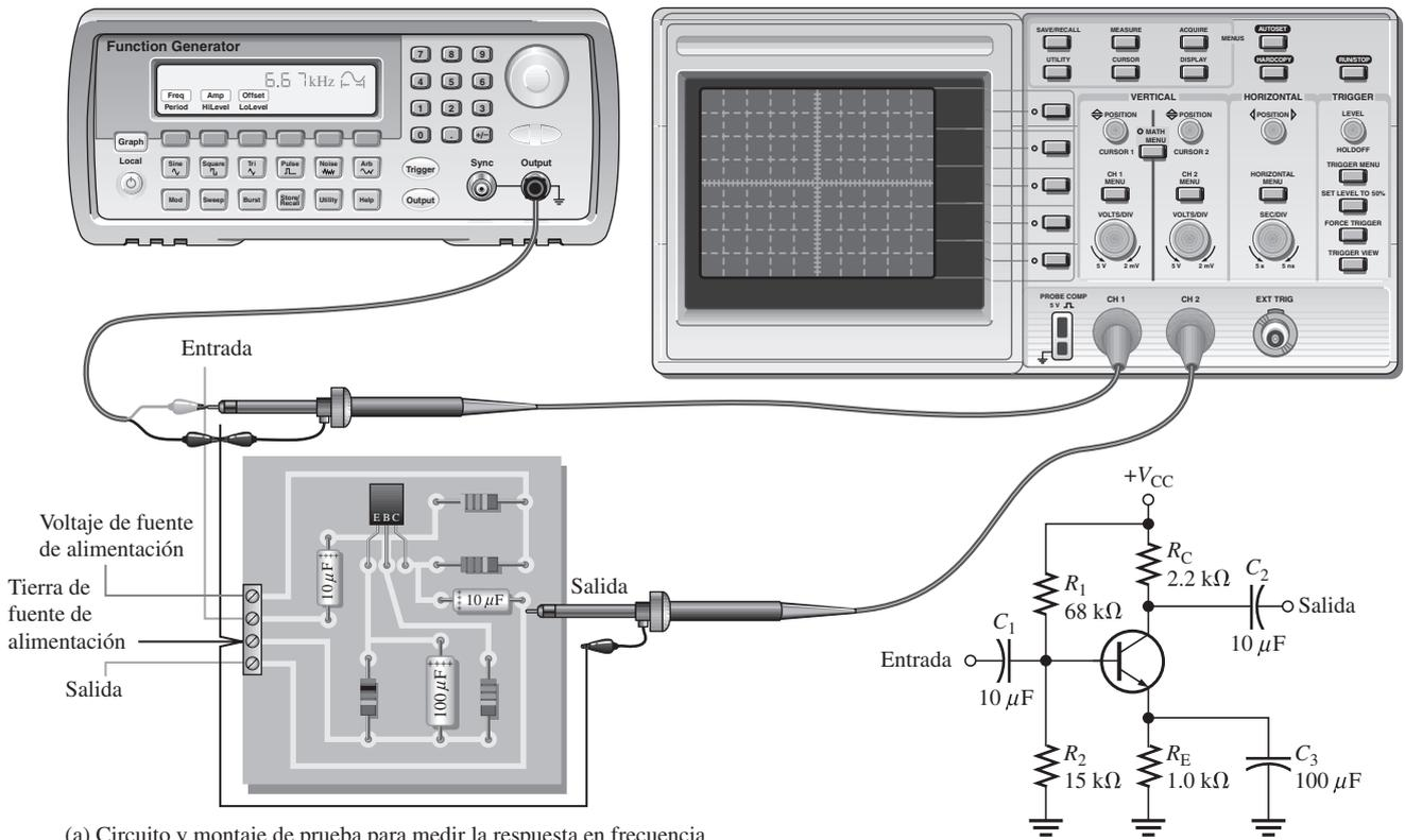
(a) Circuito y montaje de prueba para medir la respuesta en frecuencia de un amplificador
