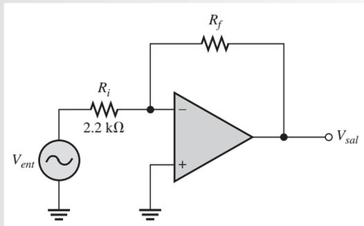
**Solución** Sabiendo que  $R_i = 2.2 \text{ k}\Omega$  y que el valor absoluto de la ganancia en lazo cerrado es  $|A_{cl(I)}| = 100$ , calcule  $R_f$  de la siguiente manera:
