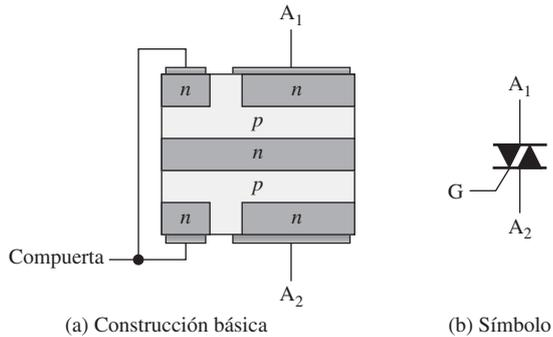
La curva de característica se muestra en la figura 11-28. Observe que el potencial de ruptura se reduce a medida que se incrementa la corriente en la compuerta, exactamente como con el SCR. Como con otros tiristores, el triac deja de conducir cuando la corriente en el ánodo se reduce por debajo del valor especificado de la corriente de retención,  $I_H$ . La única forma de apagar el triac es reducir la corriente a un nivel suficientemente bajo.
