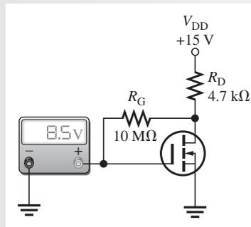
**Solución** El medidor indica  $V_{GS} = 8.5 \text{ V}$ . Puesto que ésta es una configuración de realimentación del drenaje  $V_{DS} = V_{GS} = 8.5 \text{ V}$ .
