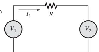
La corriente  $I_{1(\text{prom})}$  en el circuito de capacitores conmutados es igual a  $I_1$  en el circuito resistivo. ▲ FIGURA B-5
