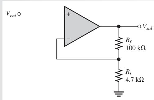
**Solución** Esta es una configuración de amplificador operacional no inversor. Por consiguiente, la ganancia de voltaje en lazo cerrado es
