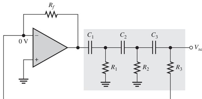
La atenuación  $B$ , de circuito RC de realimentación de tres secciones es
