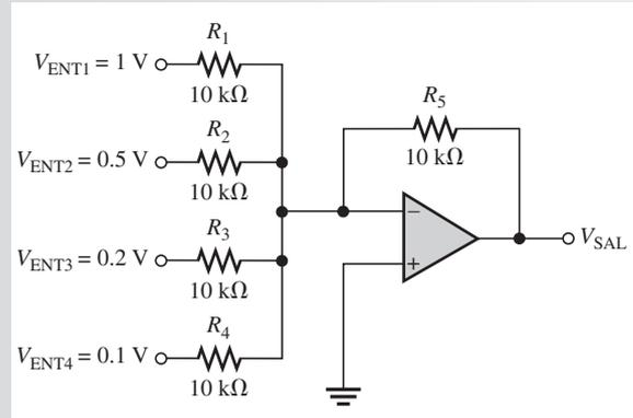
**Solución** (a)  $V_{SAL} = -(V_{ENT1} + V_{ENT2} + \dots + V_{ENTn})$
