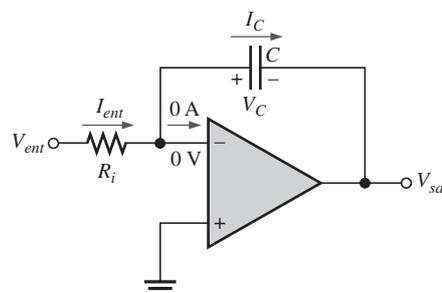
Si  $V_{ent}$  es un voltaje constante, entonces  $I_{ent}$  también lo es porque la entrada inversora siempre permanece a 0 V y mantiene constante el voltaje a través de  $R_i$ . Debido a la impedancia de entrada muy alta del amplificador operacional, existe una corriente despreciable en la entrada inversora. Esto hace que toda la corriente de entrada circule a través del capacitor, como se indica en la figura 13-32, por lo tanto
