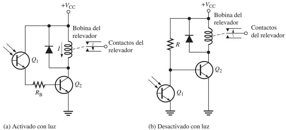
La figura 4-30(b) muestra un circuito en el cual un relevador es desactivado por la luz incidente sobre el fototransistor. Cuando la luz es insuficiente, el transistor  $Q_2$  se polariza y mantiene el relevador energizado. Cuando la luz es suficiente, el fototransistor  $Q_1$  se prende; esto lleva a la base de  $Q_2$  a un nivel bajo y  $Q_2$  se apaga y desenergiza el relevador.
