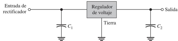
En la figura 2-33 se muestra una fuente de alimentación fija básica con un regulador de voltaje de +5 V. En el capítulo 17 se estudian los reguladores de tres terminales integrado con voltajes de salida fijos.
