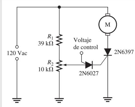
El SCR utilizado en el control de velocidad del motor es el 2N6397 de canal *n*. La hoja de datos parcial se muestra en la figura 11-47. El PUT es el 2N6027 y su hoja de datos parcial también se muestra en el figura 11-47.
