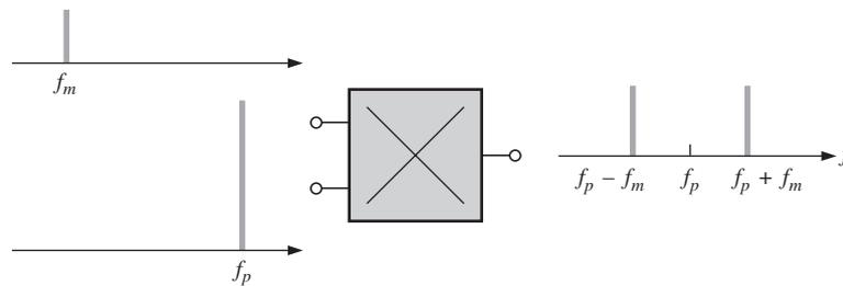
◀ FIGURA 18-18 El amplificador lineal como modulador balanceado.
