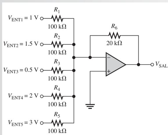
**Solución** Como los resistores de entrada son iguales,  $R = 100 \text{ k}\Omega$ ,  $R_f = R_6$ .
