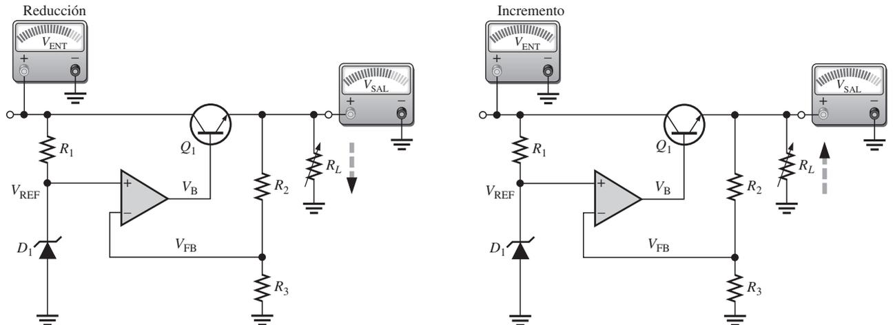
(a) Cuando  $V_{ENT}$  o  $R_L$  se reduce,  $V_{SAL}$  tiende a reducirse. El voltaje de realimentación,  $V_{FB}$ , hace lo mismo y, consecuentemente, el voltaje de salida del amplificador operacional  $V_B$  tiende a incrementarse, compensando así la reducción intentada de  $V_{SAL}$  incrementando el voltaje en el emisor de  $Q_1$ . Los cambios de  $V_{SAL}$  se exageraron para propósitos de ilustración.
