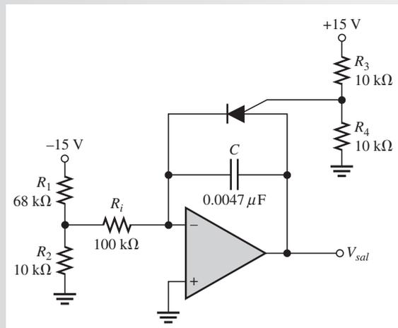
**Solución** (a) Primero determine el voltaje en la compuerta para establecer el voltaje aproximado al cual el PUT se enciende.
