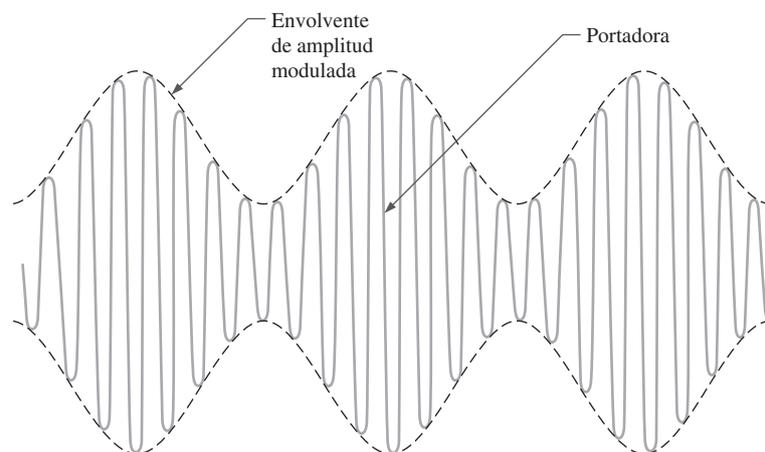
La banda de frecuencia para receptores de radio de AM es de 540 a 1640 kHz. Esto significa que un receptor de AM puede ser sintonizado para que capte una frecuencia portadora específica situada en la banda de radiodifusión. Cada estación de radio AM transmite a una frecuencia portadora específica que es diferente de cualquier otra del área, por lo que el receptor puede captar cualquier estación deseada.
