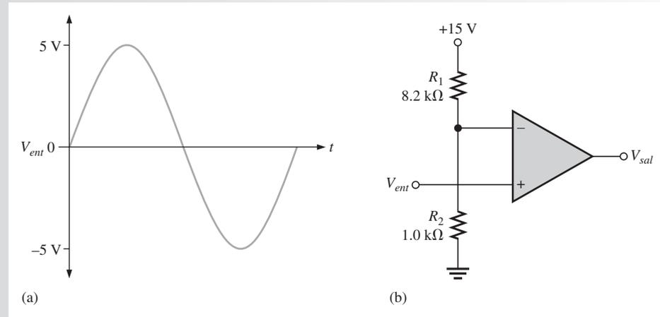
**Solución**  $R_1$  y  $R_2$  establecen el voltaje de referencia de la siguiente forma:
