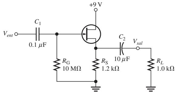
25. Si el JFET de la figura 9-64 se sustituye con uno que tenga una  $g_m$  de  $3000 \mu\text{S}$ , ¿cuál es la ganancia y la resistencia de entrada si el resto de las condiciones permanece igual?
