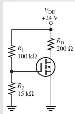
**Solución** Para el E-MOSFET mostrado en la figura 8-47, el voltaje de compuerta a fuente es
