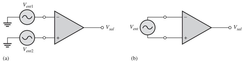
**Modo común** En el **modo común**, se aplican dos voltajes de señal de la misma fase, frecuencia y amplitud a las dos entradas, como muestra la figura 12-6. Cuando se aplican señales de entrada iguales a ambas entradas, tienden a cancelarse y el resultado es un voltaje de salida cero.
