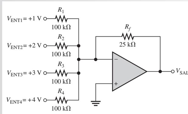
**Solución** Como los resistores de entrada son iguales,  $R = 100 \text{ k}\Omega$ . El voltaje de salida es
