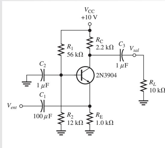
**Solución** Primero, determine  $I_E$  de modo que pueda determinar  $r'_e$ . Luego  $R_{ent} \cong r'_e$ . Como  $\beta_{CD}R_E \gg R_2$ , entonces
