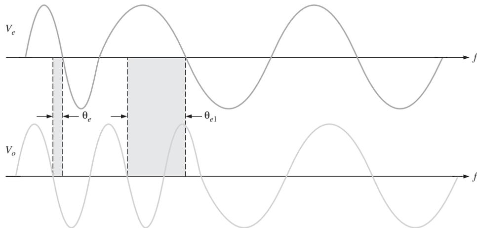
$\theta_e$  se reduce a  $\theta_{e1}$  como se ilustra en la figura 18-45. Esta reducción de  $\theta_e$  hace que el voltaje de control del VCO se incremente y por lo tanto,  $f_o$  se reduce hasta que  $f_o = f_e$  y el PLL se mantiene enganchado.
