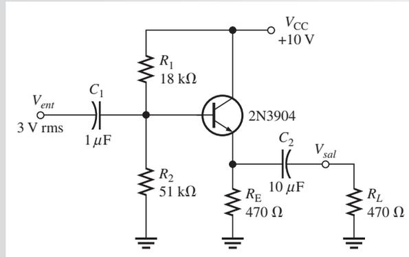
**Solución** La resistencia de ca en el emisor externa al transistor es
