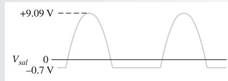
**Problema relacionado** Describa la forma de onda de salida en la figura 2-35 si  $R_1$  cambia a  $1\text{ k}\Omega$ .
