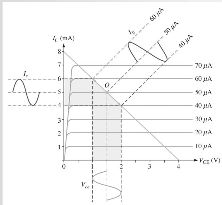
**Solución** Las proyecciones en la gráfica de la figura 6-4 muestran la corriente en el colector variando desde 6 mA hasta 4 mA para un valor pico a pico de **2 mA**, y el voltaje en el colector con respecto al emisor variando desde 1 V hasta 2 V para un valor pico a pico de **1 V**.
