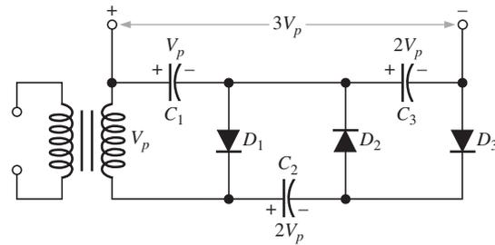
ciclo negativo,  $C_2$  se carga a  $2V_p$  por conducto de  $D_2$ , como se describió para el duplicador. Durante el siguiente semiciclo positivo,  $C_3$  se carga a  $2V_p$  por conducto de  $D_3$ . La salida del triplificador se toma a través de  $C_1$  y  $C_3$ , como se muestra en la figura.
