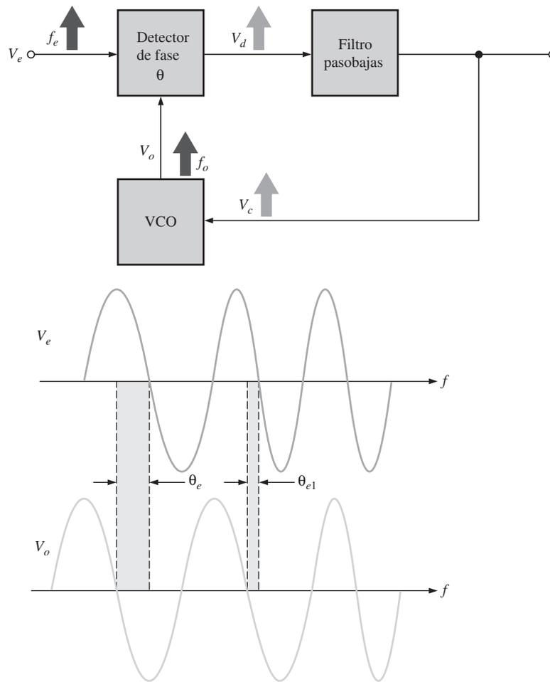
de fase. El intervalo de enganche es independiente del ancho de banda del filtro pasobajas porque cuando el PLL está enganchado, la diferencia de frecuencias ( $f_e - f_o$ ) es cero o un valor instantáneo comprendido dentro del ancho de banda. El intervalo de enganche normalmente se expresa como un porcentaje de la frecuencia del VCO.
