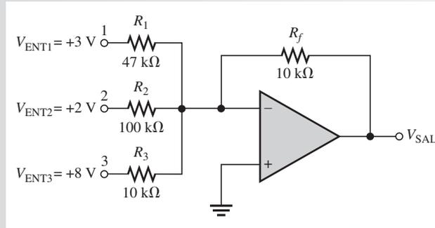
**Solución** Peso de la entrada 1:  $\frac{R_f}{R_1} = \frac{10 \text{ k}\Omega}{47 \text{ k}\Omega} = \mathbf{0.213}$
