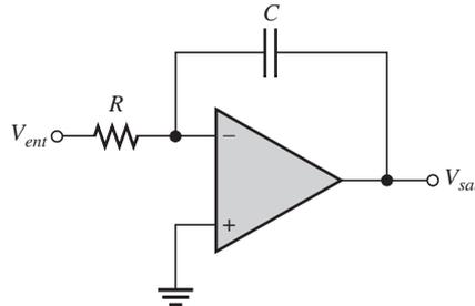
**Cómo se carga un capacitor** Para entender cómo funciona un integrador es importante revisar cómo se carga un capacitor. Recuerde que la carga  $Q$  en un capacitor es proporcional a la corriente de carga ( $I_C$ ) y al tiempo ( $t$ ).
