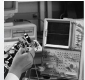
En las configuraciones básicas de amplificador operacional, existen sólo unos cuantos componentes que pueden fallar. Éstos son el resistor de realimentación, el resistor de entrada y el potenciómetro utilizado para compensar el desequilibrio de voltaje. Además, naturalmente, el amplificador operacional mismo puede fallar o puede haber falsos contactos en el circuito. Examine las tres configuraciones básicas en cuanto a posibles fallas y los síntomas asociados.
