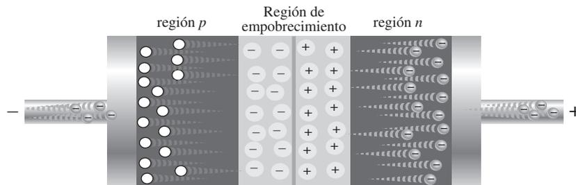
En la región  $p$ , los electrones procedentes del lado negativo de la fuente de voltaje entran como electrones de valencia y se desplazan de hueco en hueco hacia la región de empobrecimiento, donde crean iones negativos adicionales. Esto ensancha la región de empobrecimiento y agota los portadores mayoritarios. El flujo de electrones de valencia puede ser considerado como huecos que están siendo “jalados” hacia el lado positivo.
