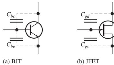
Las hojas de datos a menudo se refieren a la capacitancia de un BJT,  $C_{bc}$ , como la capacitancia de salida, designada a menudo como  $C_{ob}$ . La capacitancia  $C_{be}$  a menudo se designa como la capacitancia de entrada  $C_{ib}$ . Las hojas de datos de los FET normalmente especifican la capacitancia de entrada  $C_{iss}$  y la capacitancia de transferencia en inversa  $C_{rss}$ . Con éstas, se pueden calcular  $C_{gs}$  y  $C_{gd}$ , como se verá en la sección 10-4.
