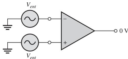
Esta acción se llama *rechazo en modo común*. Su importancia radica en la situación en la que aparece una señal indeseada en ambas entradas del amplificador operacional. Rechazo en modo común significa que esta señal indeseada no aparecerá en la salida y distorsionará la señal deseada. Las señales en modo común (ruido) en general son el resultado de la captación de energía irradiada en las líneas de entrada, de líneas adyacentes, la línea de transmisión de 60 Hz u otras fuentes.
