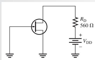
**Solución** En vista de que  $V_{GS(corte)} = -4$  V,  $V_P = 4$  V. El valor mínimo de  $V_{DS}$  para que el JFET esté en región de corriente constante es
