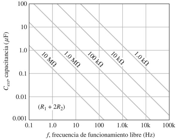
El tiempo durante el cual la salida está baja ( $t_L$ ) es el tiempo que le lleva a  $C_{ext}$  para descargarse desde  $\frac{2}{3}V_{CC}$  hasta  $\frac{1}{3}V_{CC}$ . Se expresa como
