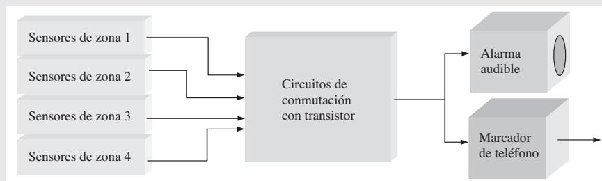
Un sensor de zona detecta cuando una ventana o puerta se abre. Normalmente están en la posición cerrada y están conectados en serie a una fuente de voltaje de cd, como se muestra en la figura 4-48(a). Cuando una ventana o puerta se abre, el sensor correspondiente crea un circuito abierto, como se muestra en la parte (b). Los sensores están representados por símbolos de interruptores.
