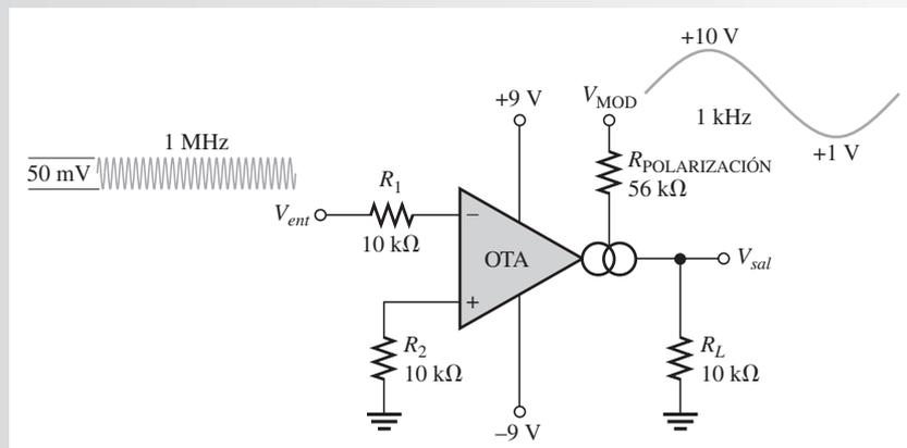
**Solución** La ganancia de voltaje máxima ocurre cuando  $I_{\text{POLARIZACIÓN}}$ , y por lo tanto  $g_m$ , es máxima. Esto ocurre en el pico máximo del voltaje modulador,  $V_{\text{MOD}}$ .
