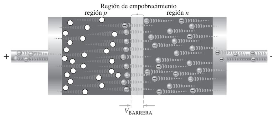
La fuente de voltaje de polarización proporciona suficiente energía a los electrones libres para que venzan el potencial de barrera de la región de empobrecimiento y continúen moviéndose hacia la región  $p$ . Una vez que llegan a la región  $p$ , estos electrones de conducción han perdido suficiente energía para combinarse de inmediato con los huecos presentes en la banda de valencia.
