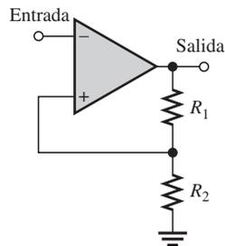
$$V_{UTP} = \frac{R_2}{R_1 + R_2} (+V_{sal(m\acute{a}x)})$$
