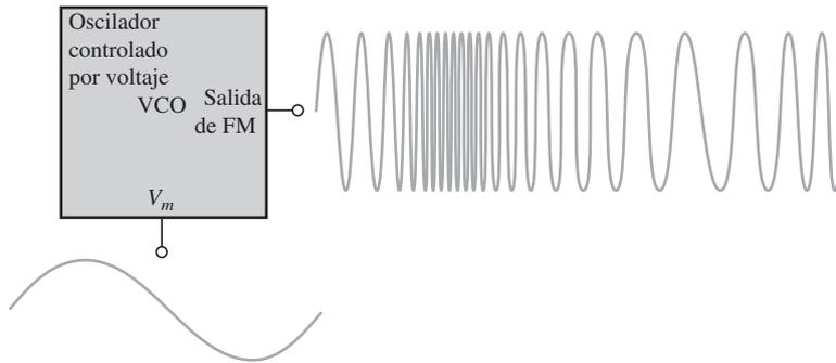
En general, se utiliza un oscilador controlado por voltaje de reactancia variable en aplicaciones de FM. El VCO de reactancia variable utiliza el diodo varactor como capacitancia variable, como se ilustra en la figura 18-39, donde la capacitancia varía con el voltaje modulador,  $V_m$ .
