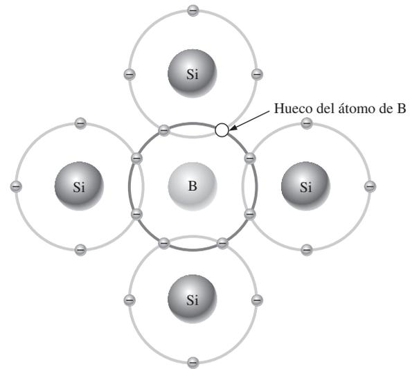
huecos son los portadores mayoritarios en un material tipo  $p$ . Aunque la mayoría de los portadores de corriente en un material tipo  $p$  son huecos, también existen algunos electrones de banda de conducción que se crean cuando térmicamente se generan pares electrón-hueco. Estos electrones de banda de conducción *no* se producen por la adición de átomos de impureza trivalentes. Los electrones de banda de conducción en un material tipo  $p$  son los portadores minoritarios.
