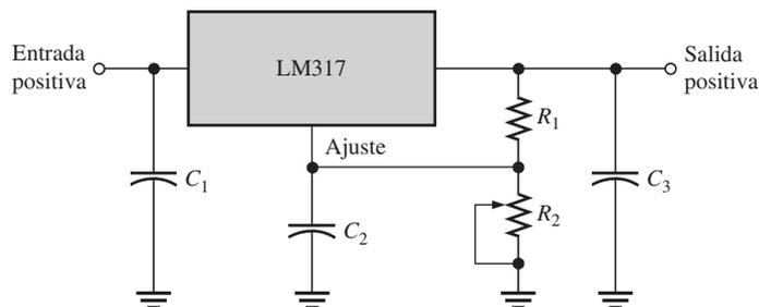
El LM317 opera como regulador “flotante” porque la terminal de ajuste no está conectada a tierra, sino que flota de acuerdo con cualquiera que sea el voltaje a través de  $R_2$ . Esto permite que el voltaje de salida sea mucho más alto que el de un regulador de voltaje fijo.
