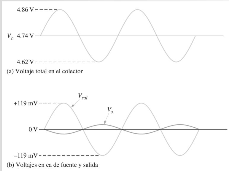
como se indica en la figura 6-23(b). Se muestra esta fuente de voltaje para enfatizar la inversión de fase.
