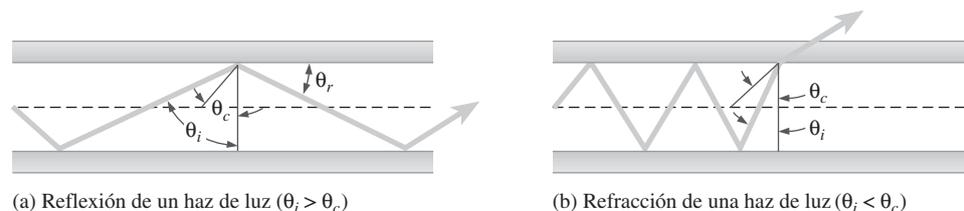
El material de núcleo y el material del revestimiento tienen un parámetro conocido como **índice de refracción**, el cual determina el ángulo crítico. Éste se define por la fórmula
