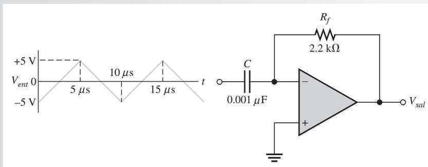
**Solución** Partiendo de  $t = 0$ , el voltaje de entrada es una rampa que tiende a un valor positivo desde  $-5 \text{ V}$  hasta  $+5 \text{ V}$  (un cambio de  $+10 \text{ V}$ ) en  $5 \mu\text{s}$ . Luego cambia a una rampa que tiende a un valor negativo desde  $+5 \text{ V}$  hasta  $-5 \text{ V}$  (un cambio de  $-10 \text{ V}$ ) en  $5 \mu\text{s}$ .
