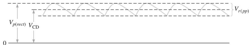
Para un rectificador de onda completa con un filtro de entrada con capacitor, en las siguientes ecuaciones se dan aproximaciones del voltaje de rizo pico a pico,  $V_{r(pp)}$  y el valor de cd del voltaje de salida del filtro,  $V_{CD}$ . El  $V_{p(rect)}$  es el voltaje rectificado pico no filtrado. Observe que si  $R_L$  o  $C$  se incrementa, el voltaje de rizo se reduce y el voltaje de cd se incrementa.
