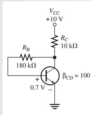
**Solución** Con la ecuación 5-11 se obtiene la corriente en el colector como
