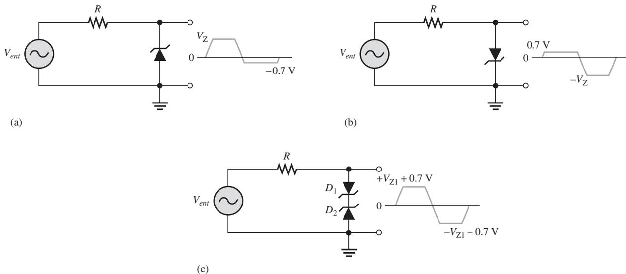
▲ FIGURA 3-18 Acción limitadora básica del zener con voltaje de entrada senoidal.
