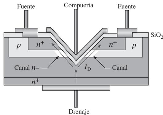
**TMOSFET** La estructura de canal vertical del TMOSFET se ilustra en la figura 8-42. La estructura de la compuerta está incrustada en una capa de bióxido de silicio y el contacto de fuente es continuo sobre toda el área de superficie. El drenaje se encuentra en la parte inferior. El TMOSFET permite una mayor densidad de encapsulado que el VMOSFET, al mismo tiempo que retiene la ventaja del canal vertical corto.
