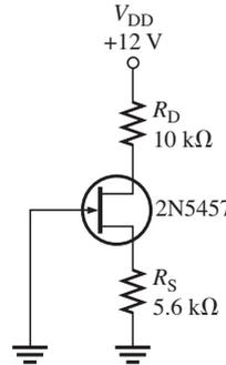
67. Determine la  $I_D$  y el  $V_{GS}$  máximos para el circuito de la figura 8-82.
