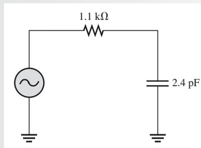
**Problema relacionado** Si se utiliza otro transistor con  $C_{bc} = 5 \text{ pF}$  en el amplificador, ¿cuál es  $f_{cu(salida)}$ ?
