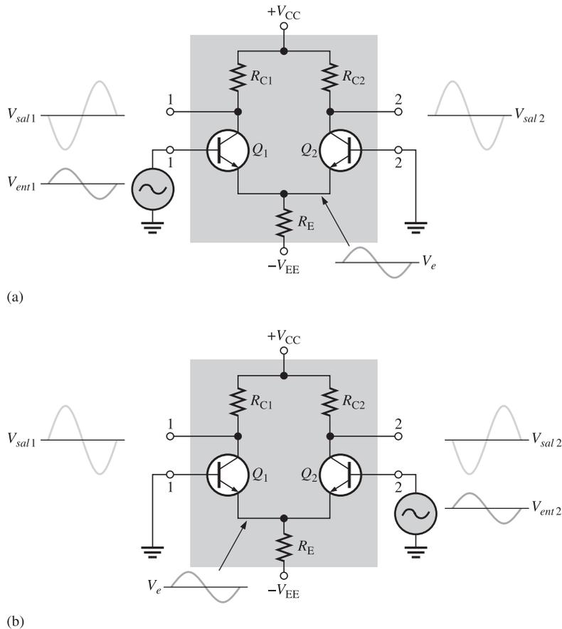
**Entradas diferenciales por las dos terminales** En esta configuración, se aplican dos señales de polaridad opuesta (desfasadas) a las entradas, como muestra la figura 6-40(a). Cada entrada afecta las salidas, como se verá en el siguiente análisis.
