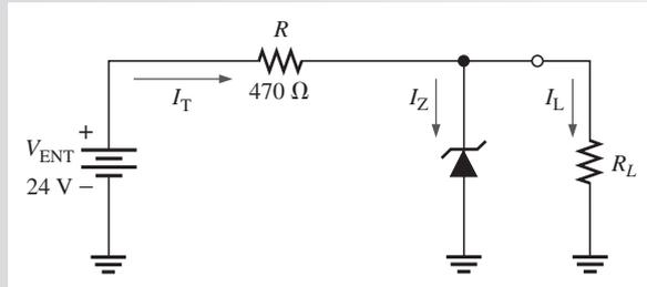
**Solución** Cuando  $I_L = 0$  A ( $R_L = \infty$ ),  $I_Z$  es máxima e igual a la corriente total en el circuito,  $I_T$ .
