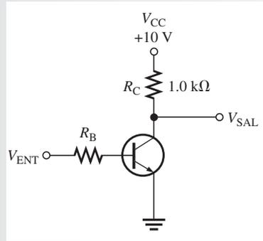
**Solución** (a) Cuando  $V_{ENT} = 0$  V, el transistor está en corte (actúa como un interruptor abierto) y
