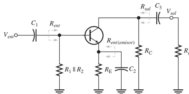
El capacitor de acoplamiento de entrada  $C_1$  y la resistencia de entrada del amplificador forman un circuito  $RC$ . El segundo circuito  $RC$  se forma por el capacitor de acoplamiento de salida  $C_3$ , la resistencia viendo hacia el colector ( $R_{sal}$ ) y la resistencia de carga. El tercer circuito  $RC$  que afecta la respuesta en baja frecuencia se forma por el capacitor de puenteo  $C_2$  en el emisor y la resistencia viendo hacia el emisor.
