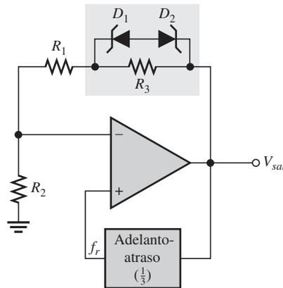
ción de cd por primera vez, ambos diodos zener aparecen como se estuvieran abiertos. Esto coloca a  $R_3$  en serie con  $R_1$ , por lo que la ganancia en lazo cerrado del amplificador se incrementa de la siguiente manera ( $R_1 = 2R_2$ ):
