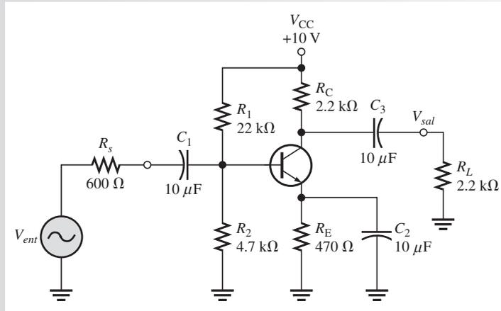
**Solución** Calcule la capacitancia de salida Miller
