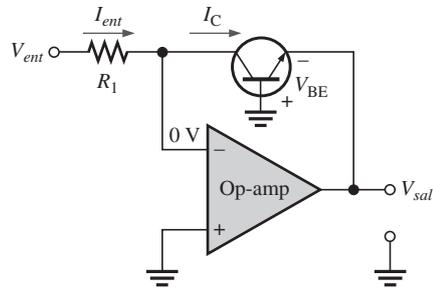
El análisis de este circuito es igual al del amplificador logarítmico con diodo, excepto porque  $V_{BE}$  reemplaza a  $V_F$ ,  $I_C$  reemplaza a  $I_F$  e  $I_{EBO}$  reemplaza a  $I_R$ . La expresión para el  $V_{BE}$  contra la curva de la característica  $I_C$  es
