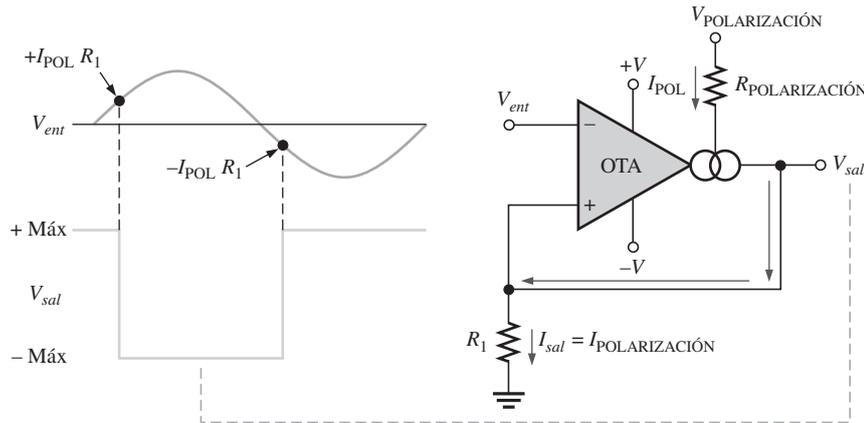
◀ FIGURA 14-28 Operación básica del disparador de Schmitt de un OTA.
