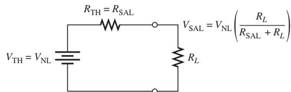
Sea  $R_{FL}$  igual la resistencia de carga de valor más pequeño (corriente de valor más grande), entonces el voltaje de salida a plena carga ( $V_{FL}$ ) es
