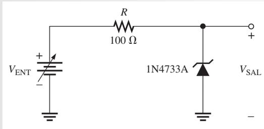
**Solución** De acuerdo con la hoja de datos de la figura 3-7 para el 1N4733A:  $V_Z = 5.1 \text{ V}$  con  $I_Z = 49 \text{ mA}$ ,  $I_{ZK} = 1 \text{ mA}$  y  $Z_Z = 7 \Omega$  en  $I_Z$ . Por simplicidad, suponga este valor de  $Z_Z$  dentro del intervalo de valores de corriente. El circuito equivalente se muestra en la figura 3-12.
