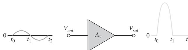
**El punto Q está en la región de corte** El amplificador clase B se polariza en la región de corte de modo que  $I_{CQ} = 0$  y  $V_{CEQ} = V_{CE(corte)}$ . Se hace que abandone la región de corte y opere en su región lineal cuando la señal de entrada hace que el transistor conduzca. Esto se ilustra en la figura 7-7 con un circuito seguidor-emisor donde la salida no es una réplica de la entrada.
