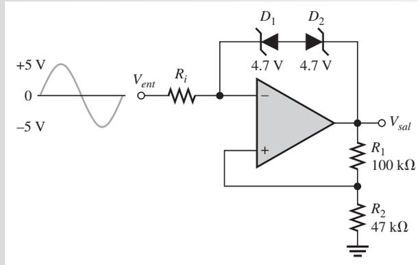
El voltaje en la entrada inversora (-) de un amplificador operacional es  $V_{sal} \pm 5.4 \text{ V}$ . Como el voltaje diferencial es despreciable, el voltaje en la entrada no inversora (+) del amplificador operacional también es aproximadamente  $V_{sal} \pm 5.4 \text{ V}$ . Por lo tanto,
