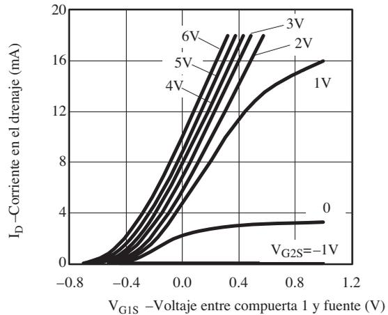
54. Consulte la figura 8-61 y trace la curva de transconductancia ( $I_D$  vs.  $V_{GS1}$ ).
