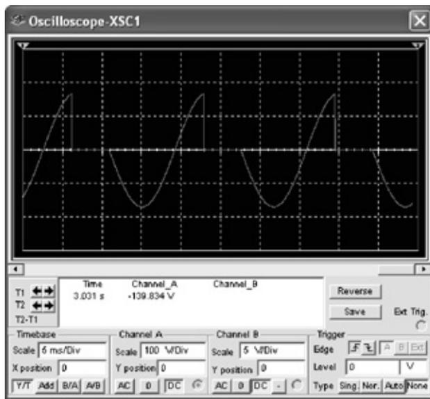
(a) Voltaje a través del SCR con  $V_{\text{cont}} = 14.2 \text{ V}$
