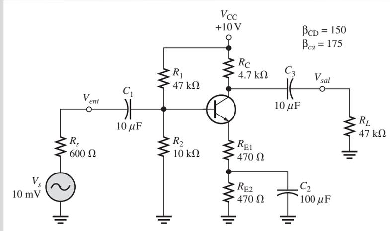
**Solución** (a) Determine los valores de polarización en cd utilizando el circuito equivalente que aparece en la figura 6-21.
