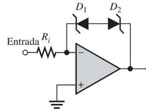
$$+V_{sal(m\acute{a}x)} = V_{Z1} + 0.7 \text{ V}$$
