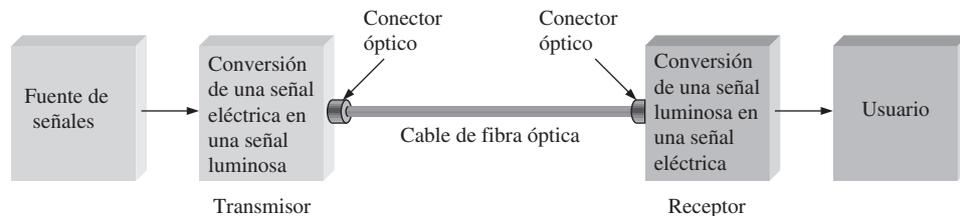
La señal eléctrica modula la intensidad de la luz y produce una señal luminosa que porta la misma información que la señal eléctrica. Un conector especial acopla entonces la señal luminosa al cable de fibra óptica. En el otro extremo el receptor remodula la señal luminosa y convierte de vuelta en la señal eléctrica original.
