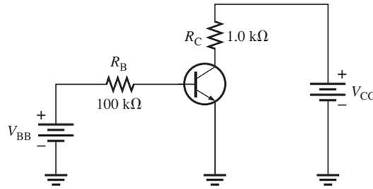
13. Calcule  $\alpha_{CD}$  para el transistor del problema 12.
