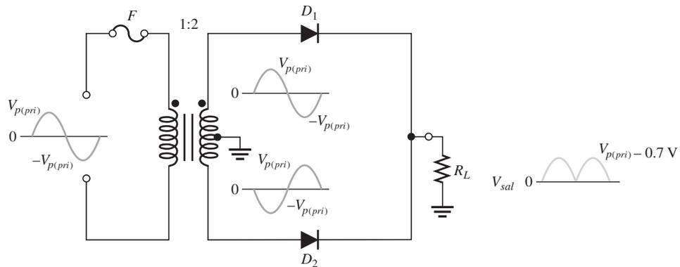
En cualquier caso, el voltaje de salida de un rectificador de onda completa con derivación central siempre es la mitad del voltaje del secundario menos la caída en el diodo, independientemente de la relación de vueltas existente.
