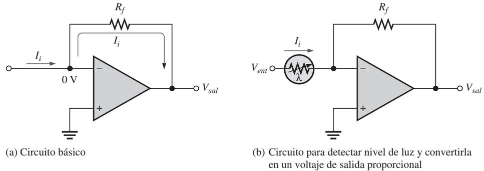
Una aplicación específica de este circuito se ilustra en la figura 14-37(b), donde se utiliza una fotocelda para detectar cambios del nivel de luz. A medida que cambia la luz, la corriente a través de la fotocelda varía debido al cambio de resistencia de ésta. Este cambio de resistencia produce un cambio proporcional en el voltaje de salida ( $\Delta V_{sal} = \Delta I_i R_f$ ).
