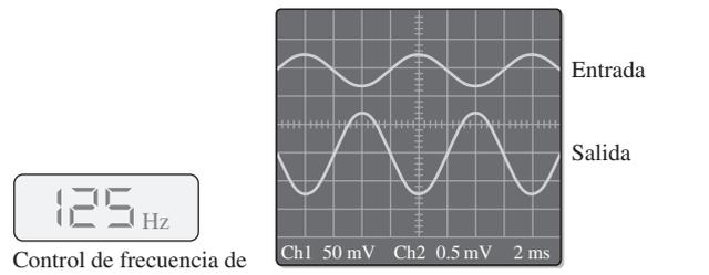
Control de frecuencia de entrada en el generador de funciones
