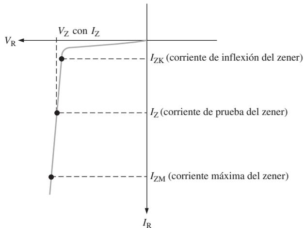
**Regulación zener** La característica clave del diodo zener es su capacidad de mantener el voltaje en inversa esencialmente constante a través de sus terminales. Un diodo zener que opera en condición de ruptura actúa como regulador de voltaje porque mantiene un voltaje casi constante a través de sus terminales durante un intervalo especificado de valores de corriente en inversa.
