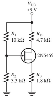
68. Determine el intervalo de posibles valores del punto Q desde el mínimo hasta el máximo para el circuito de la figura 8-81.
