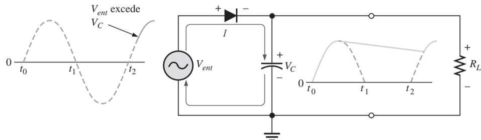
(c) El capacitor se carga otra vez a su valor pico de entrada cuando el diodo se polariza en directa. Esta carga ocurre durante la parte del voltaje de entrada indicada por la curva continua.
