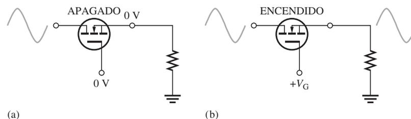
Cuando el interruptor está *conectado* como se ilustra en la figura 9-35, el voltaje mínimo de compuerta a fuente ocurre en el instante del pico negativo de la señal. La diferencia de  $V_G$  y  $-V_{p(sal)}$  es el voltaje de compuerta a fuente en el instante del pico y debe ser igual a o mayor que  $V_{GS(umbral)}$  para mantener el MOSFET en conducción.
