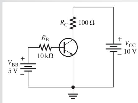
**Solución** De acuerdo con la ecuación 4-3,  $V_{BE} \cong 0.7 \text{ V}$ . Calcule la corriente de base, de colector y de emisor de la siguiente manera:
