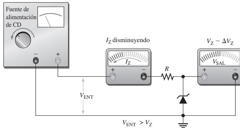
(b) A medida que el voltaje de entrada se reduce, el voltaje de salida permanece casi constante ( $I_{ZK} < I_Z < I_{ZM}$ ).
