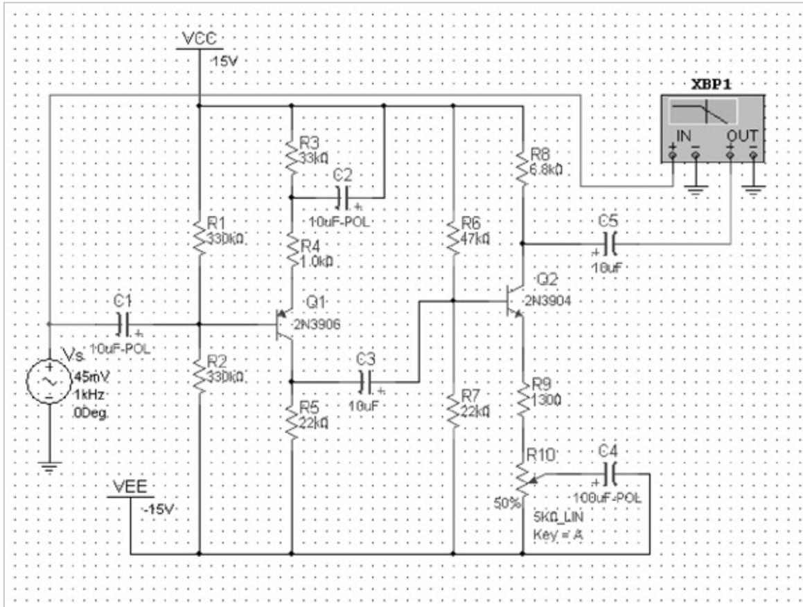
(a) Pantalla de circuito con valores de capacitores originales
