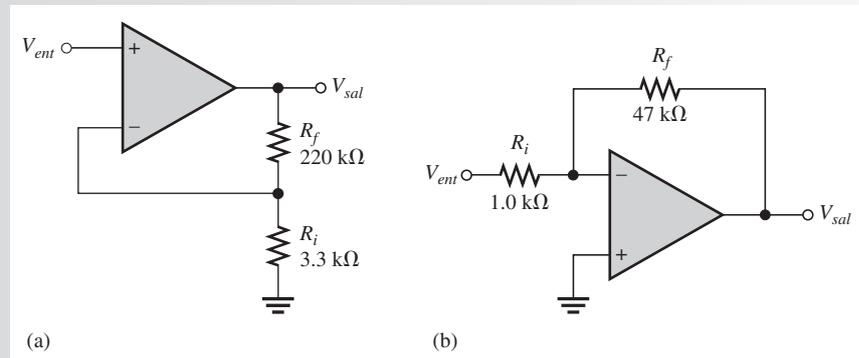
**Solución** (a) Para el amplificador no inversor de la figura 12-43(a), la ganancia en lazo cerrado es
