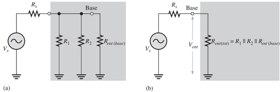
Como se puede ver en la figura, el voltaje de alimentación,  $V_s$ , se divide entre  $R_s$  (resistencia de la fuente) y  $R_{ent(tot)}$ , de modo que el voltaje de señal en la base del transistor se calcula con la fórmula del divisor de voltaje de la siguiente manera:
