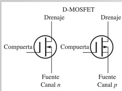
Pueden ser operados en los modos de empobrecimiento o de enriquecimiento.  $V_{GS}$  puede tener una u otra polaridad cuando se polariza con  $V_{GS} = 0$  V.
