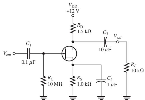
11. Si se aplica una señal de entrada de 50 mV rms al amplificador de la figura 9-56, ¿cuál es el voltaje de salida pico a pico?  $g_m = 5000$   $\mu$ S.
