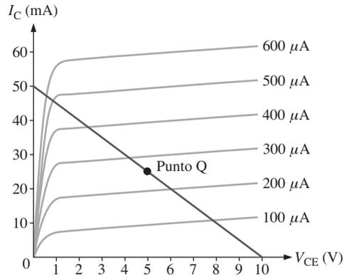
9. Con las curvas características de colector y la recta de carga de cd en la figura 5-36, determine lo siguiente:
