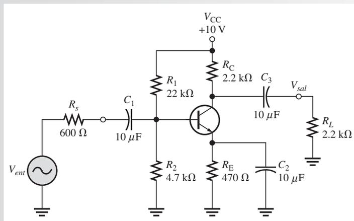
circuito de entrada. La hoja de datos del transistor da la siguiente información:  $\beta_{ca} = 125$ ,  $C_{be} = 20$  pF y  $C_{bc} = 2.4$  pF.
