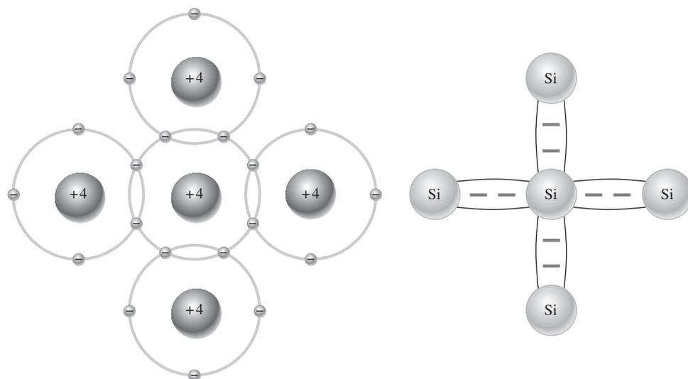
(a) El átomo de silicio central comparte un electrón con cada uno de los cuatro átomos de silicio circundantes, con lo que se crea un enlace covalente con cada uno. Los átomos circundantes están a su vez enlazados con los otros átomos, y así sucesivamente.
