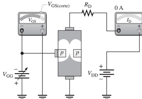
La operación básica de un JFET de canal  $p$  es igual a la de un dispositivo de canal  $n$  excepto, porque un JFET de canal  $p$  requiere un  $V_{DD}$  negativo y un  $V_{GS}$  positivo, como ilustra la figura 8-10.
