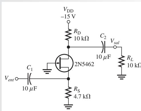
**Solución** En la hoja de datos de la figura 9-21,  $g_m = 2000 \mu\text{S}$  mínimo. Este amplificador en compuerta común tiene un resistor de carga, así que la resistencia efectiva en el drenaje es  $R_D \parallel R_L$  y la ganancia de voltaje mínima es
