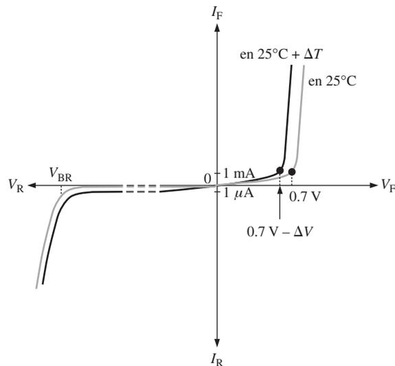
Para un diodo polarizado en inversa, a medida que se incrementa la temperatura la corriente de polarización en inversa se incrementa. La diferencia de las dos curvas se muestra exagerada en la gráfica de la figura 1-29 con fines de ilustración. Tenga en cuenta que la corriente de polarización en inversa por debajo de la ruptura permanece extremadamente pequeña y, en términos generales, puede ser ignorada.
