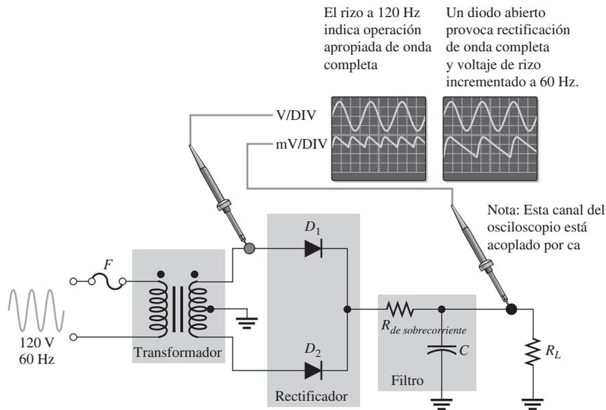
Un diodo abierto en un rectificador de puente de onda completa producirá el mismo síntoma que en el circuito con derivación central, como se muestra en la figura 2-63. El diodo abierto impide que circule corriente a través de  $R_L$  durante la mitad del ciclo de voltaje de entrada. El resultado es rectificación de media onda, la cual duplica el voltaje de rizo a 60 Hz.
