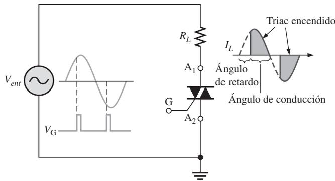
Un ejemplo de control de fase por medio de un triac se ilustra en la figura 11-31(a). Se utilizan diodos para proporcionar pulsos de disparo a la compuerta del triac. El diodo  $D_1$  conduce durante el semiciclo positivo. El valor de  $R_1$  fija el punto en el semiciclo positivo donde el triac se dispara. Observe que durante esta parte del ciclo,  $A_1$  y G son positivos con respecto a  $A_2$ .
