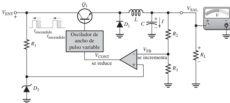
(b) Cuando  $V_{SAL}$  intenta incrementarse, el tiempo de encendido de  $Q_1$  se reduce.
