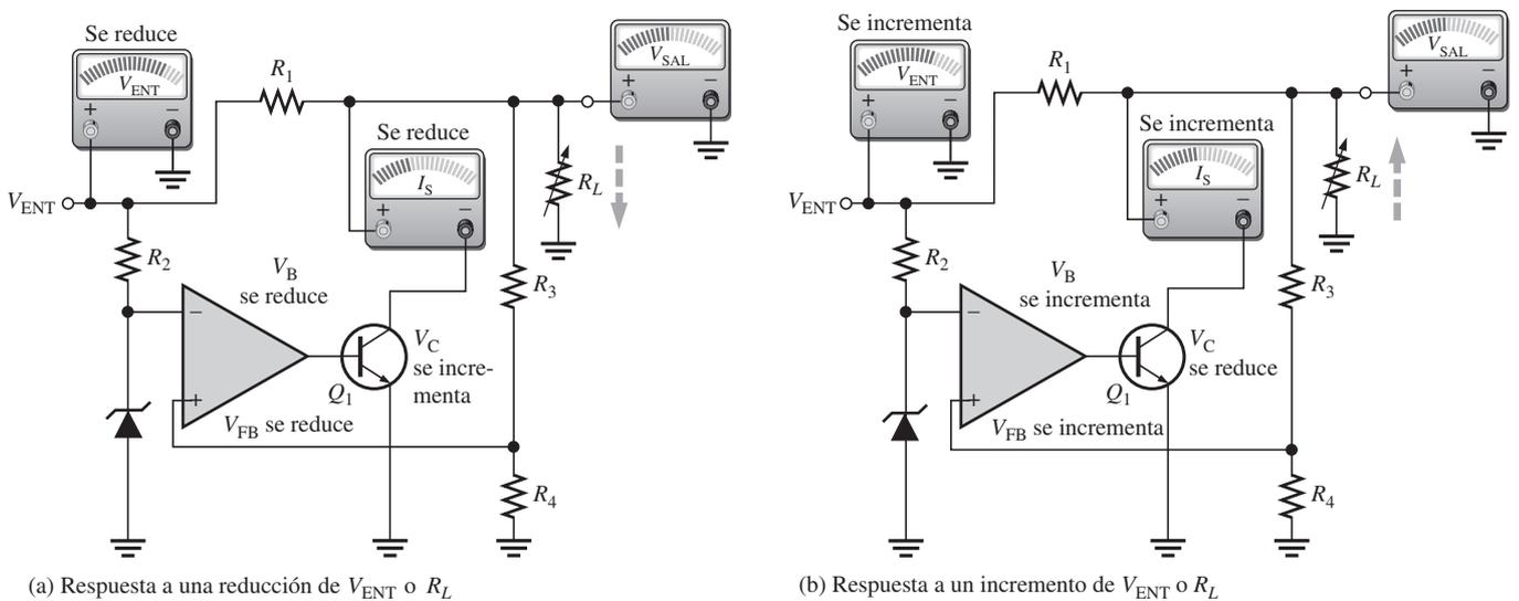
▲ FIGURA 17-14 Secuencia de respuestas cuando  $V_{SAL}$  trata de reducirse a consecuencia de una reducción de  $R_L$  o  $V_{ENT}$  (respuestas opuestas con un incremento intentado).
