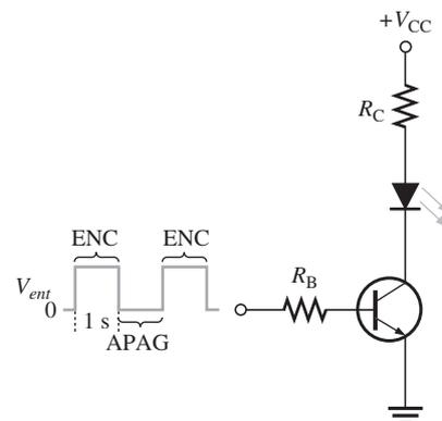
mo se indica. Cuando la onda cuadrada es de 0 V, el transistor está en corte; y en vista de que no hay corriente en el colector, el LED no emite luz. Cuando la onda cuadrada alcanza un nivel alto, el transistor se va a saturación. Esto polariza en directa el LED, y la corriente resultante en el colector que pasa a través del LED hace que emita luz. De este modo, el LED prende durante 1 segundo y se apaga durante 1 segundo.
