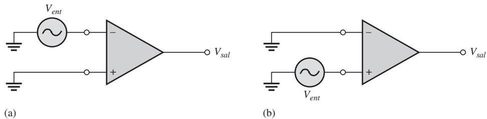
En el modo diferencial de dos terminales se aplican dos señales de polaridad opuesta (desfasadas) a las entradas, como muestra la figura 12-5(a). La diferencia entre las dos entradas aparece a la salida amplificada. De forma equivalente, el modo diferencial de dos extremos puede ser representado por una sola fuente conectada entre las dos entradas, como muestra la figura 12-5(b).
