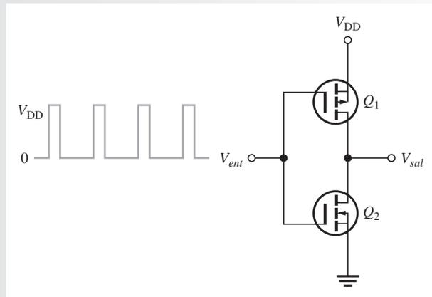
**Solución** La forma de onda de salida se muestra en la figura 9-45 en relación con la entrada. Cuando el pulso de entrada es  $V_{DD}$ ,  $Q_1$  está *apagado* y  $Q_2$  está *encendido*, conectando la salida a tierra (0 V). Cuando el pulso de entrada es 0,  $Q_1$  está *encendido* y  $Q_2$  está *apagado*, conectando la salida a  $V_{DD}$ .
