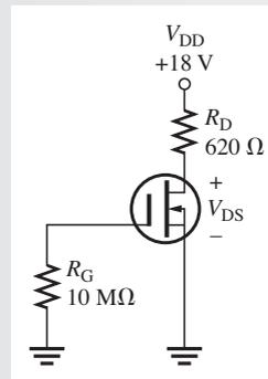
**Solución** Como  $I_D = I_{DSS} = 12 \text{ mA}$ , el voltaje de drenaje a fuente es
